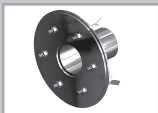
固定及活套法兰结构套管 用于DIN 18533规定的混凝土密封。 采用不锈钢制成。 内径：60-2,000 mm
