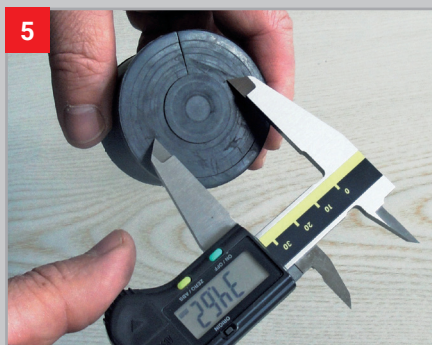
5 根据测量数据确定洋葱圈剥离的位置
